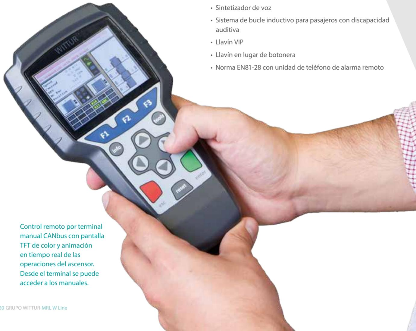
Control remoto por terminal manual CANbus con pantalla TFT de color y animación en tiempo real de las operaciones del ascensor. Desde el terminal se puede acceder a los manuales.
