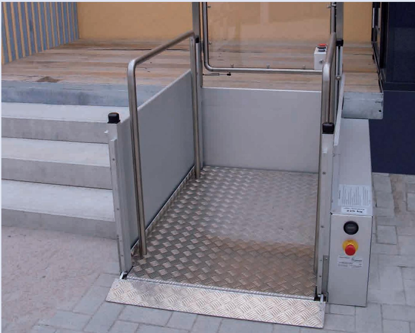
Para nuestros plataformas elevadoras de la serie HBL de funcionamiento en el espacio público, se ha desarrollado un sistema electrónico especial con una tracción en los cables, con el fin de reconocer una sobrecarga que activa un bloqueo en la unidad de conducción y del motor, el cual no permite la elevación.
